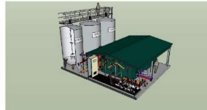
Sistema de pasteurización en continuo con recuperación de calor para 20.000 kg/h
