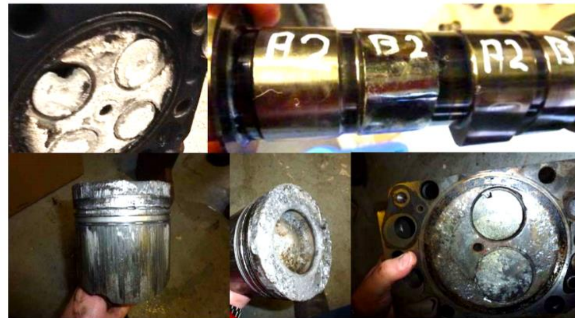
Daños que ocasiona el H 2 S y siloxanos en motores
