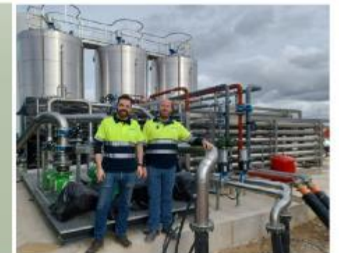
Sistema de pasteurización en continuo con recuperación de calor para 20.000 kg/h
